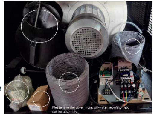
Retire la cubierta, la manguera, el separador de agua y aceite, etc. para realizar el montaje.
