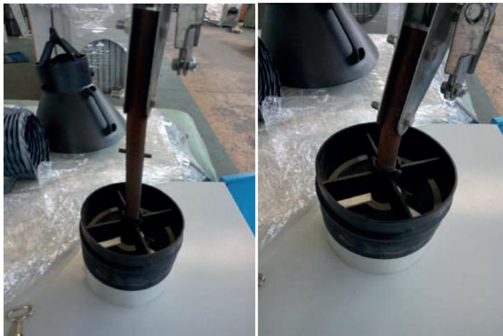
Coloque la manguera, fije la base utilizando la abrazadera de sujeción de acero inoxidable.
