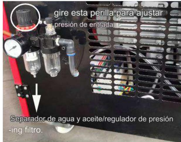
Después de conectar el aire comprimido, por favor verifique la posición del puntero del manómetro; el puntero en el rango de  $0.2 \text{ MPa}-0.4 \text{ MPa}$  estaría bien. Si no es así, gire la perilla (marcada con un círculo blanco) en la foto anterior para ajustar la presión de entrada: gire la perilla en sentido horario para aumentar la presión y en sentido antihorario para disminuir la presión.
