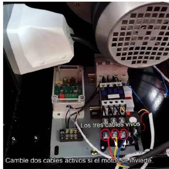
Consejo: Para el panel de control eléctrico, hay un enchufe que se conecta mediante un cable neutro y un cable vivo, que puede proporcionar una alimentación de 220V a 2 fases para luces, interruptores inductivos, detectores de humo, herramientas eléctricas de lijado de mano, etc.
