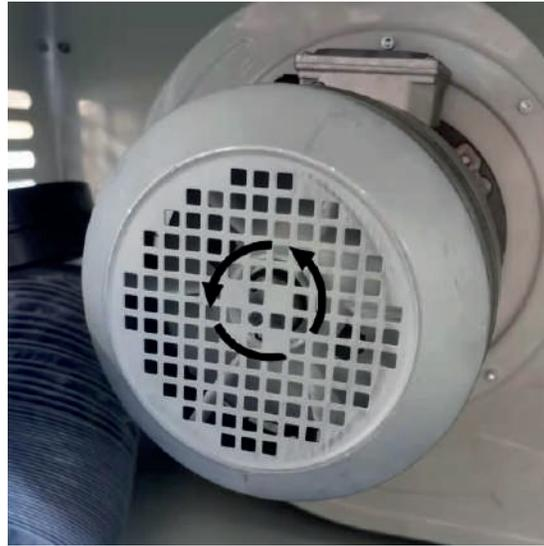
La rotación del motor en la dirección opuesta se puede solucionar cambiando las posiciones de cableado de cualquier dos cables vivos (líneas de corriente), por favor, consulte la foto siguiente:
