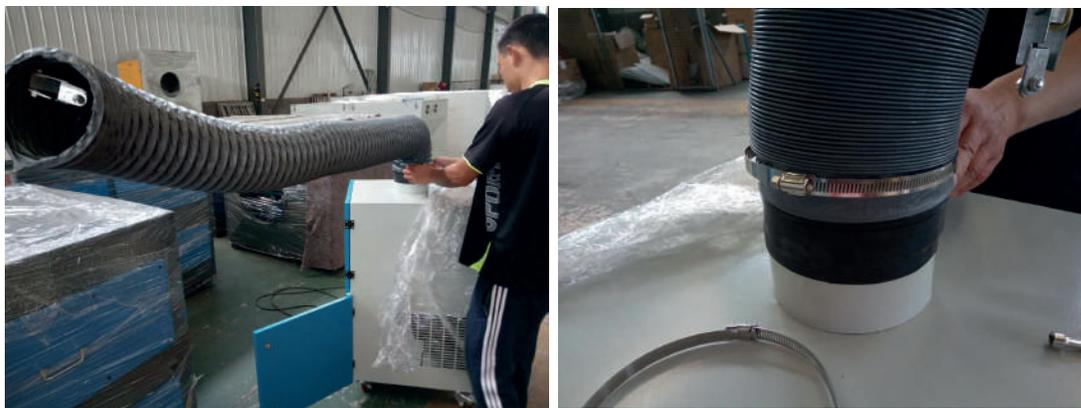
Atornille la campana de succión, luego fije la manguera y la campana de succión utilizando también la abrazadera de sujeción.
